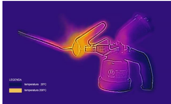
Optimalan rad plinskog topa snimljen termokamerom
